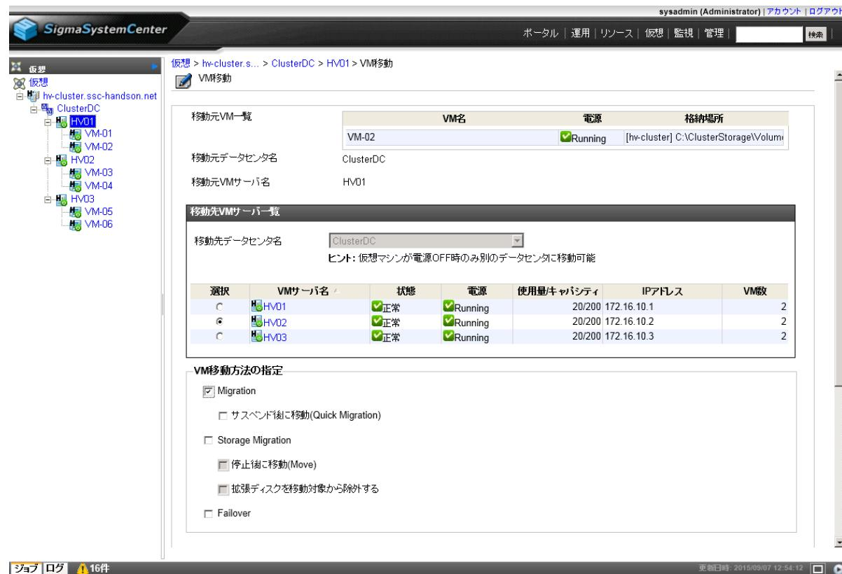
図 移動先と移動方法の選択
