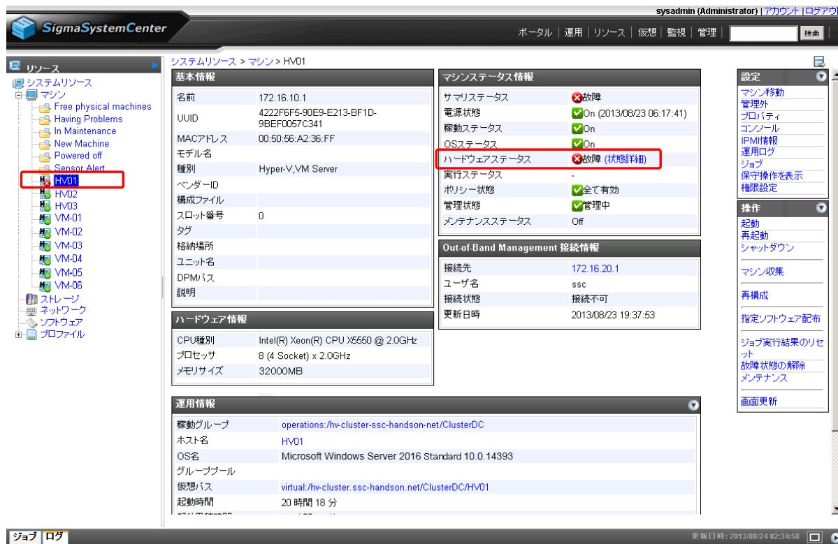
図 障害発生後の物理サーバの詳細情報（[リソース]ビュー）
