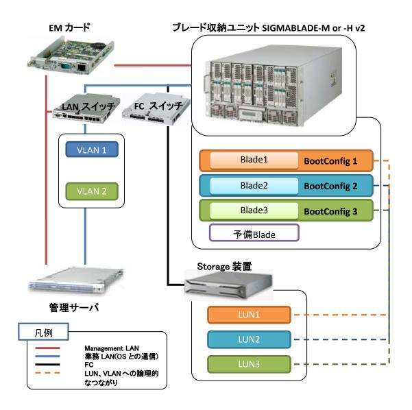
SSC は Management LAN を利用して、EM カードと通信します。 この Management LAN は、EM カードの API 利用、ブレードに障害が発生した場合に発火される PET の受信、ブレードの IPMI 制御、DPM、ESMPRO や Sysmon などで利用します。
