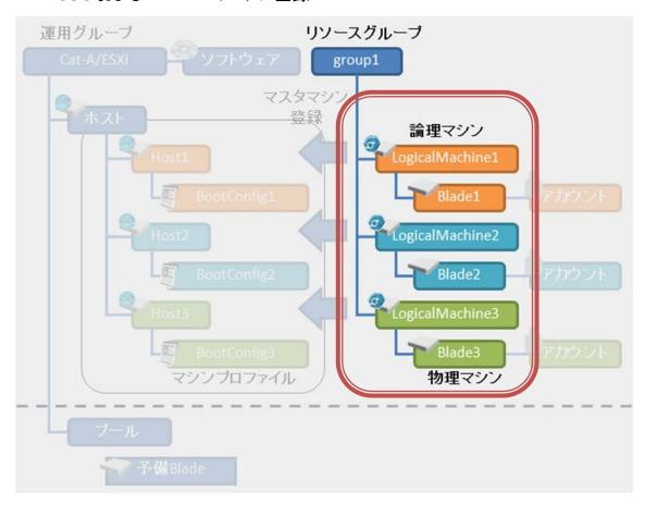
SSC で vIO コントロール機能を利用する場合、マシン登録スクリプトを実行してマシン登録を行います。マシン登録スクリプトは、指定された EM IP アドレスにアクセスして筐体内のブレード情報を参照し、SSC および DPM ヘマシン登録を行います。
