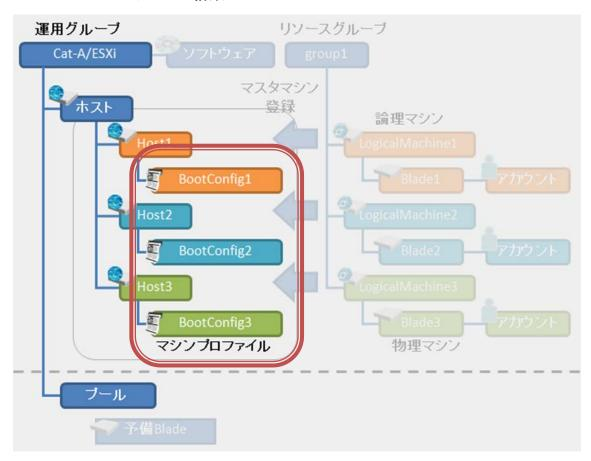
「1.2.2 マシンプロファイル」で説明したように、マシンプロファイルは、ホスト情報の一部として管理され、ホストを稼動/待機させる際に、ブートコンフィグの適用と解除、論理マシンの生成/削除に利用する情報です。マシンプロファイルは、「3.1 ブートコンフィグの運用設計と作成」で作成したブートコンフィグの情報を EM カードから取り込むことで構築します。
