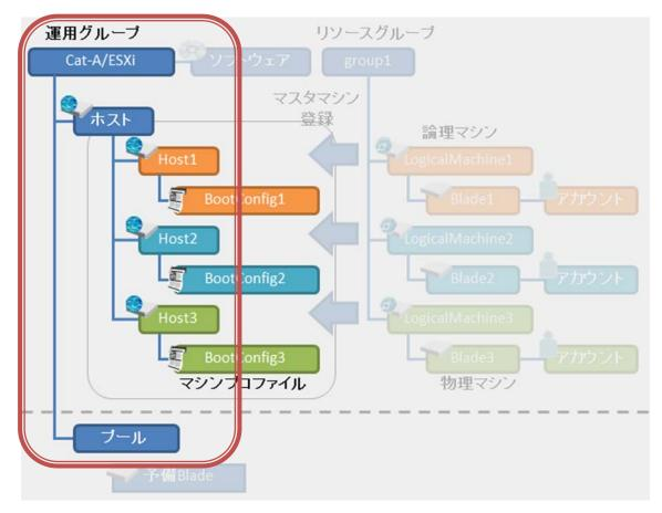
ブレードサーバをSSCで自律運用させるために、SSC上に運用グループ/ホストを設定します。 運用グループでマシンを稼動させるためには、ホストに対して、リソースを割り当てます。 ホストと は稼動させるマシンの運用定義のようなものであり、稼動時には定義に設定された情報をマシン に反映させ、マシンを稼動状態にします。
