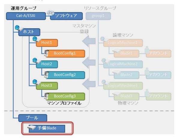
稼動中のホストに割り当てられているリソース(マシン)に障害が発生したとき、障害マシンのリソースの割り当てを解除すると同時に、プールに登録されているマシンにブートコンフィグを割り当てて稼動状態にする、N+1 置換が可能です。
