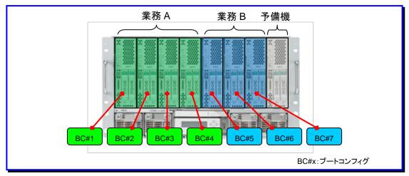
設定するブートコンフィグの数は、筐体内で稼動するホストの数と一致します。例えば、昼間は 業務 A が 4 台、業務 B が 3 台、夜間は業務 A が 3 台、業務 B が 4 台、予備機 1 台という運用を 行う場合、稼動するホストの数は業務 A が 4 台、業務 B も 4 台と数え、作成するブートコンフィグ の数は 8 個となります。
