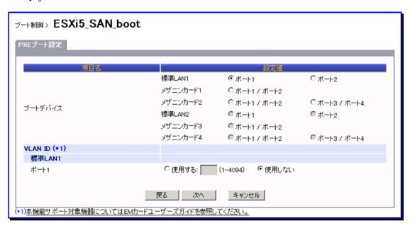
5. ブートする FC-HBA メザニンカードがささっているメザニンスロットを選択します。スロット 2 に FC-HBA メザニンカードが搭載されている場合は、[ブートデバイス]のコンボボックスから[メザニンカード 2]を選択します。
