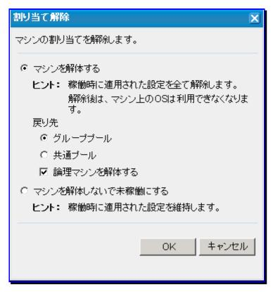
[マシンを解体する]を選択した場合に、ブートコンフィグの適用解除が行われます。このとき、 稼動していたホストに対応する論理マシンは削除され、DPM の登録からも削除されます。論理マ シンと関連付いていた物理マシンは、[戻り先]の設定に従って、グループプールに戻るか、共通プ ールに戻ります。
