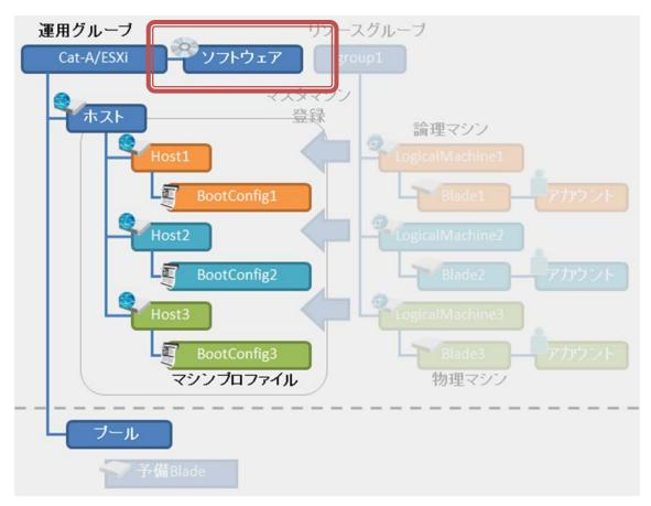
「1.2.3 ブートコンフィグの適用と解除」で説明したように、SSC はローカルスクリプト機能を利用してブートコンフィグの適用/解除/適用状況の確認を行います。
