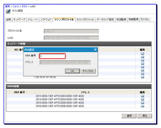
**注**: マシンの HBA に HBA 番号を設定するには、マシン-[プロパティ]-[ストレージ]タブで設定するのではなく、ホストの[プロパティ]-[マシンプロファイル]タブの WWN 情報で任意のアドレスに対して、HBA 番号を設定してください。
