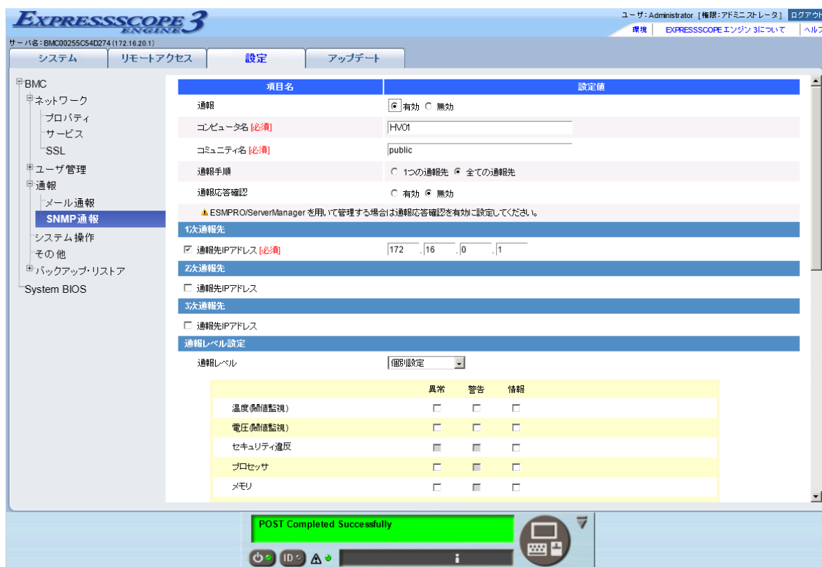
図 EXPRESSSCOPE エンジン 3 の SNMP(PET)通報の設定
