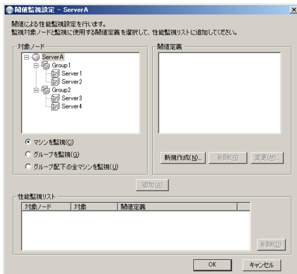
閾値監視設定ダイアログは、[対象ノード]、[閾値定義]、[性能監視リスト]から構成されています。[対象ノード]、[性能監視リスト]で設定した内容の組み合わせを[性能監視リスト]に閾値監視項目として設定します。
