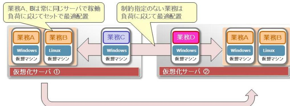
複数の仮想マシンを異なるホスト上で動作させることにより、使用するリソースを固定することなく、同時に停止したくない業務（仮想マシン）を互いに異なる仮想マシンサーバ上で動作させることができます。
