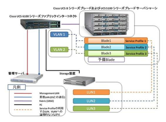
管理サーバ上の SSC は Cisco UCS 6100 シリーズファブリックインターコネクトを介して、Cisco UCS ブレードおよびブレードシャーシ(筺体)に接続します。
