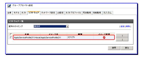
Service Profile 適用スクリプト、および解除スクリプトは、雛形を用意しています。環境に合わせて一部を編集し、所定のフォルダに格納して利用してください。スクリプトの詳細および設定方法については後述します。
