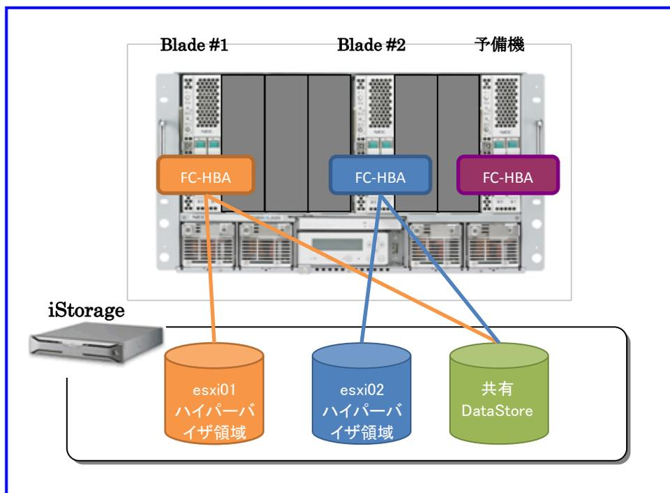
各ブレードには FC-HBA を搭載し、運用するブレードには ESXi のハイパーバイザ領域と、データストア領域を接続します。
