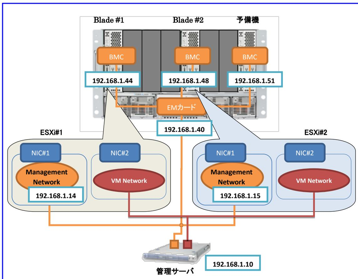
ブレードに実装されている物理 NIC を 2 枚利用して、1 枚目が管理 LAN、2 枚目を業務 LAN として構成するケースを想定します。
