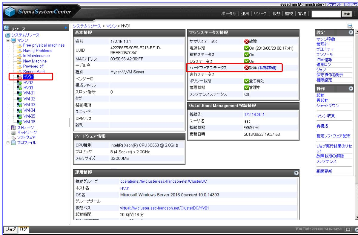
図 障害発生後の物理サーバの詳細情報 ([リソース]ビュー)
