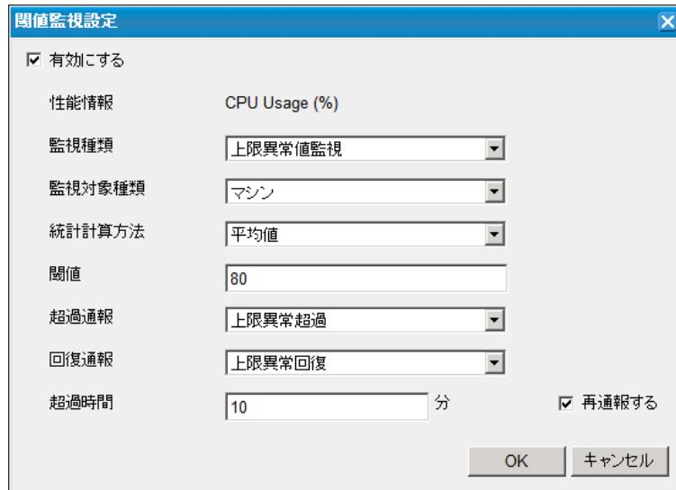
図 CPU Usage (%) の「閾値監視設定」ダイアログボックス
