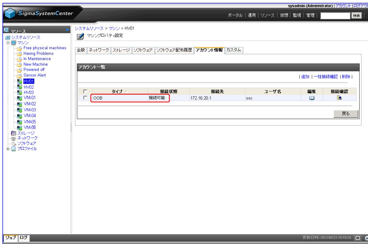
図 OOB アカウント追加後の「マシンプロパティ設定」画面（[アカウント情報]タブ）
