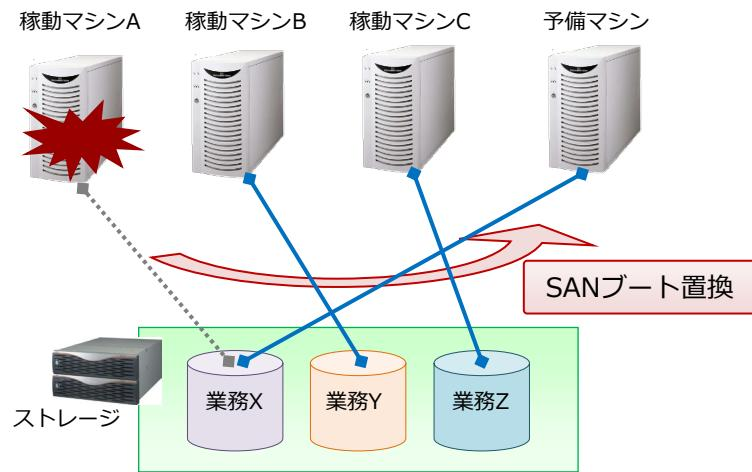
以下に、イメージ復元を利用した障害復旧の例を示します。
