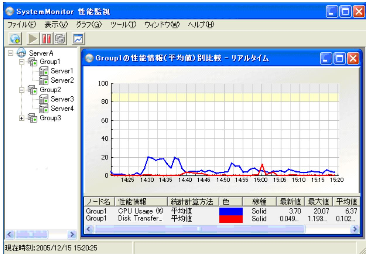
図1-3 CPU使用率とディスク転送速度の比較表示
