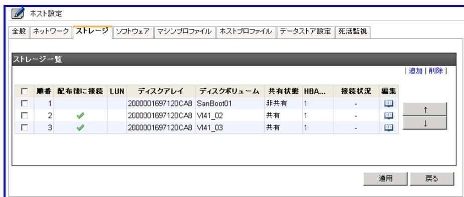
ESX / ESXi のインストール時には [配布後に接続] にチェックがないディスクのみ接続され、インストールに使用されます。インストールが完了した後に [配布後に接続] にチェックがあるディスクが接続されます。
