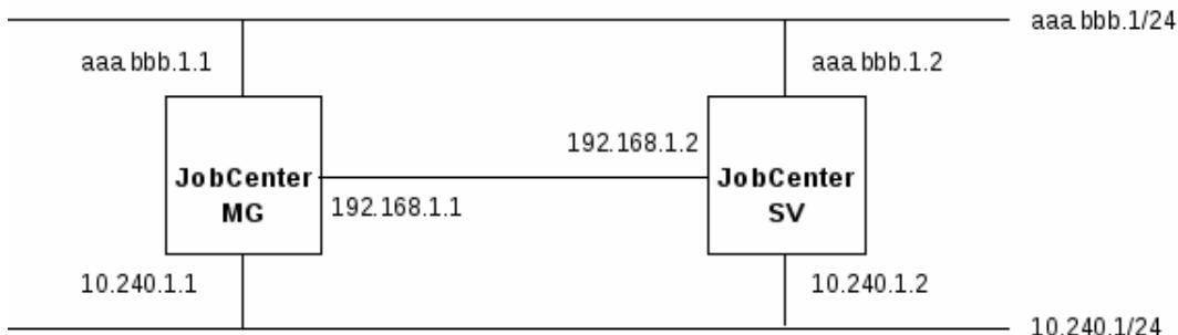
図の例ではaaa.bbb.1.1～aaa.bbb.1.2はグローバルアドレス、10.240.1.1～10.240.1.2および192.168.1.1、192.168.1.2はプライベートアドレスです。MGからSVへのジョブ転送とSVからMGへの結果返却は同じネットワークを経由するよう、ネットワークのルーティングテーブルを適切に設定する必要があります。
