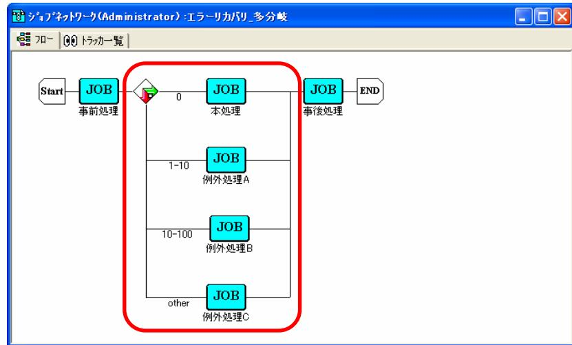
図 4-13 条件分岐の配置画面例
