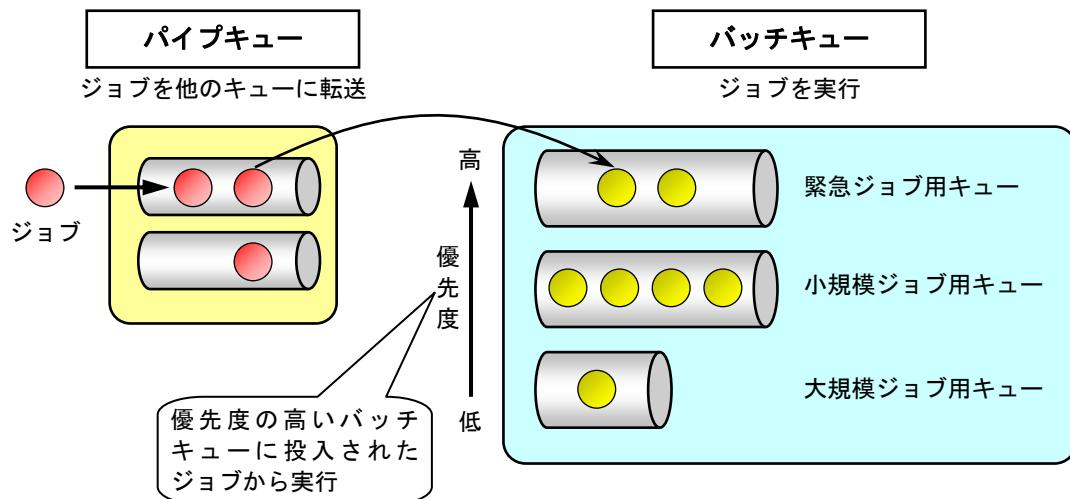
図 6-1 バッチ処理のイメージ
