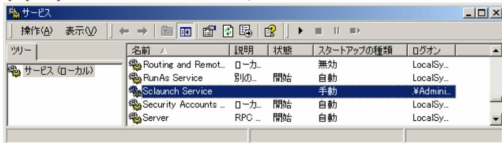
上記の操作手順で、ローカルの JobCenter SV のサービス [ComAgent Service],[jnwengine Service],[NetShepherd]のサービスの状態を[停止]にし、[スタートアップの種類]を[手動]になっていることを確認します。
