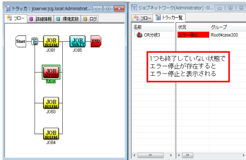
図4.40 OR分岐が1つも終了していない場合のトラッカ状態例
