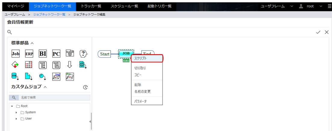
図3.31 [スクリプト] の選択画面例
