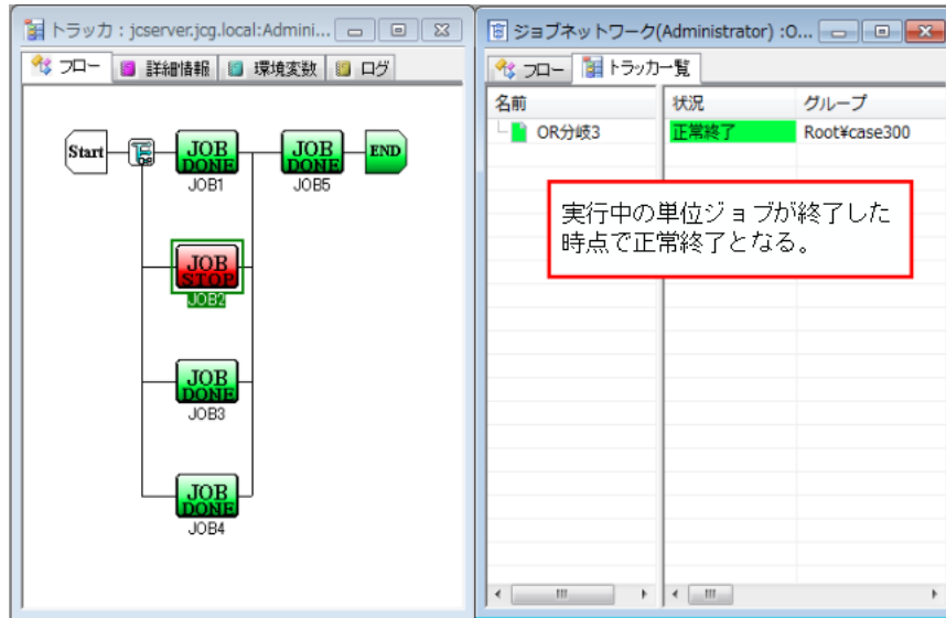
図4.44 すべての単位ジョブが終了した場合のトラッカ状態例
