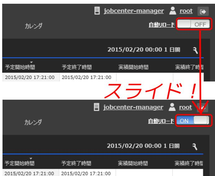
図5.37 自動リロードON状態へ変更
