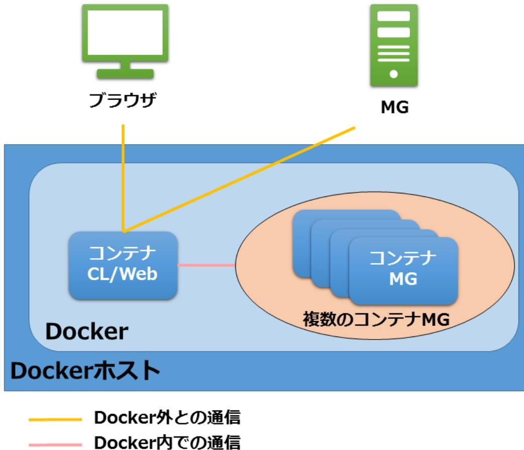
図2.6 コンテナCL/Webを中心とした構成図
