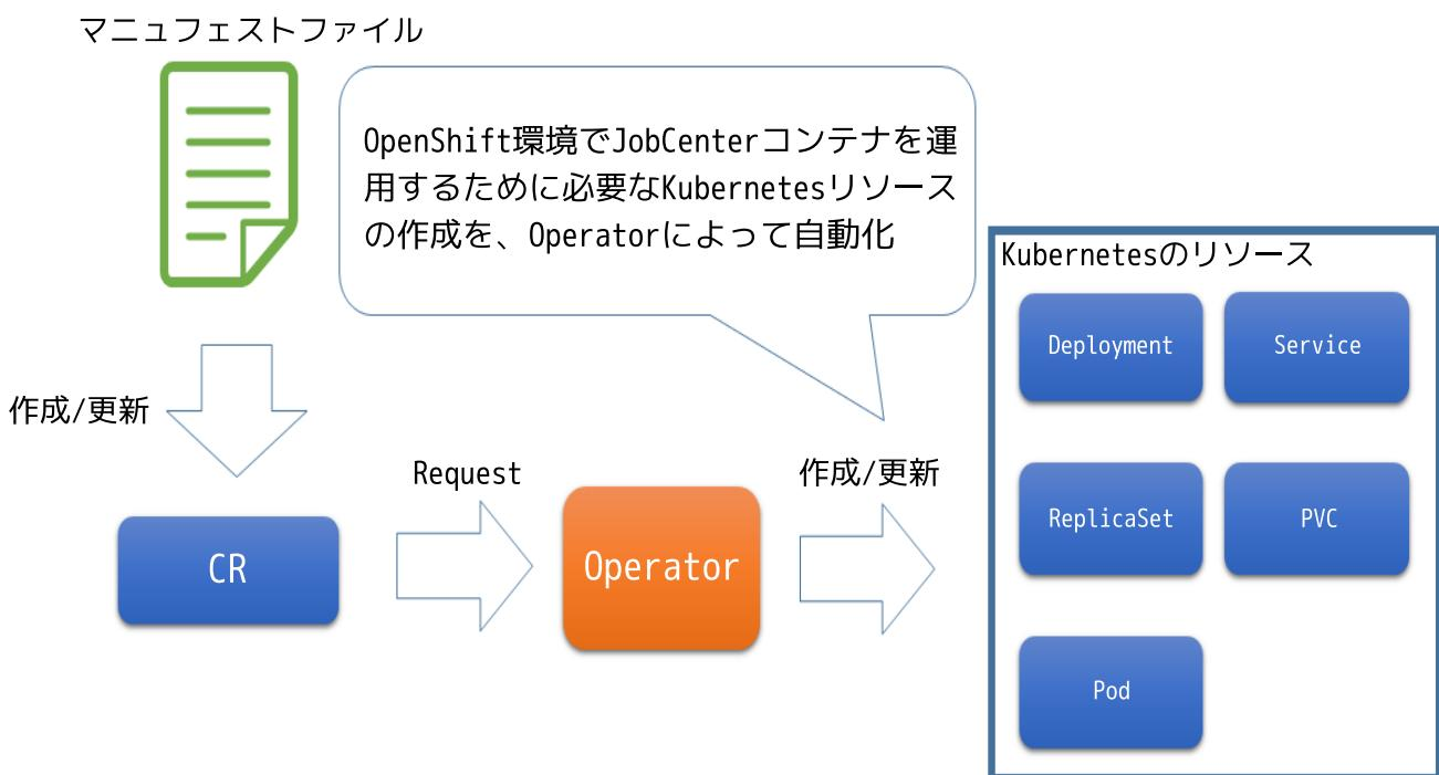
図4.1 Operatorを用いたOpenShift上でのコンテナ運用
