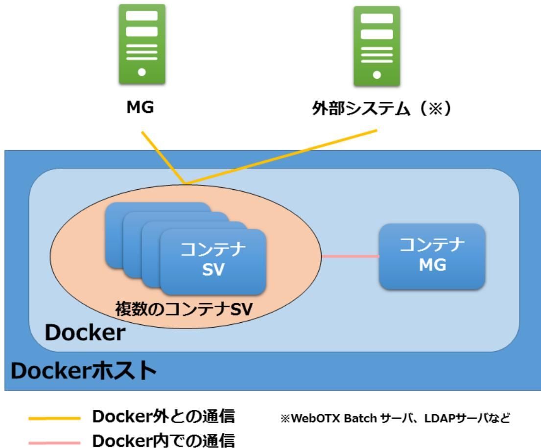
図2.5 コンテナSVを中心とした構成図
