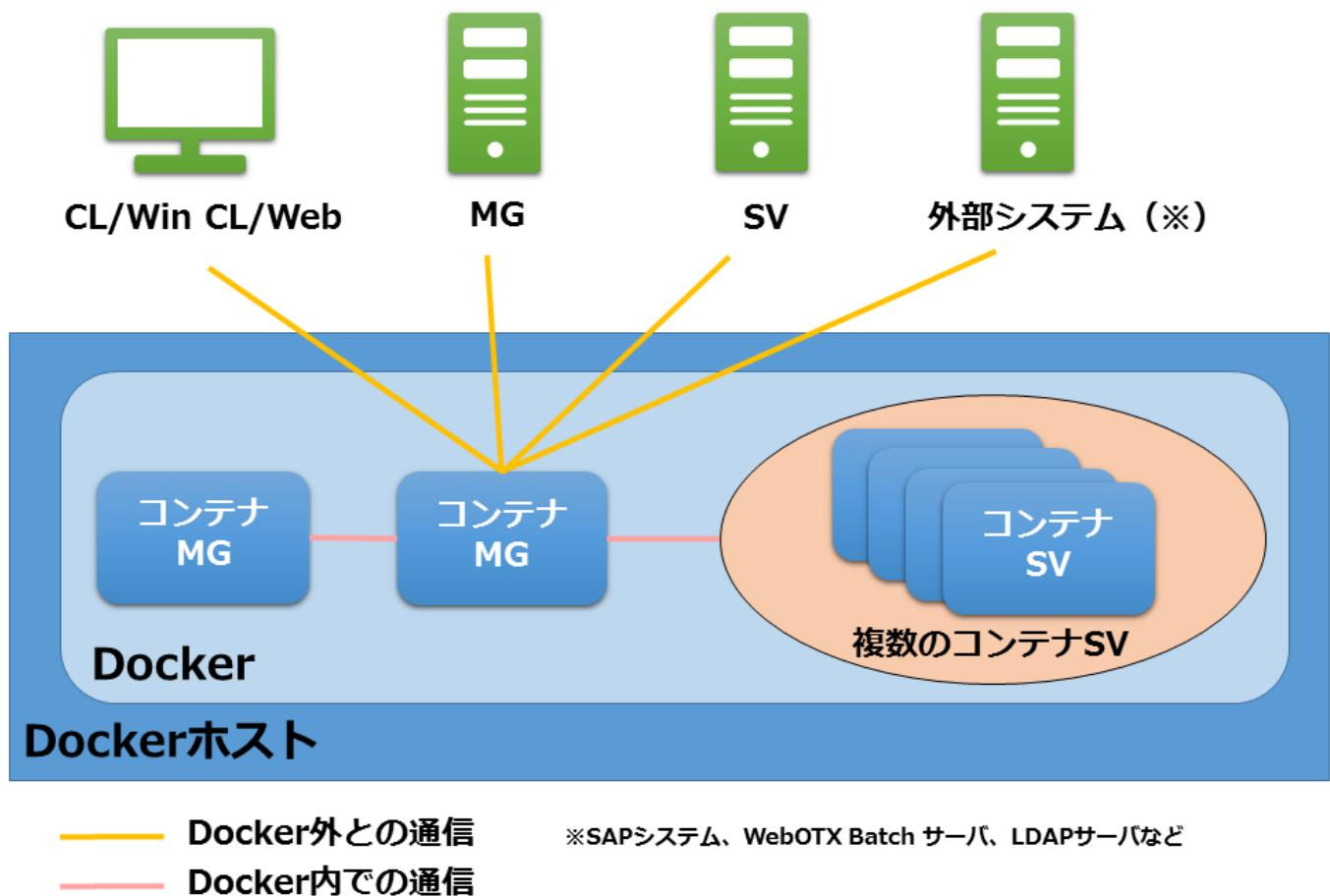
図2.4 コンテナMGを中心とした構成図
