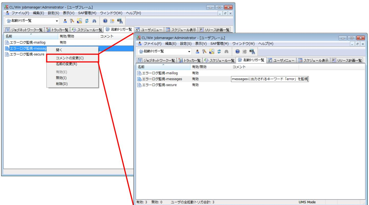
図7.7 起動トリガ定義のコメント設定
