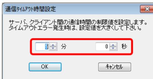
図2.8 通信タイムアウト時間の設定例
