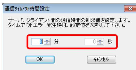
図2.10 通信タイムアウト時間の設定例
