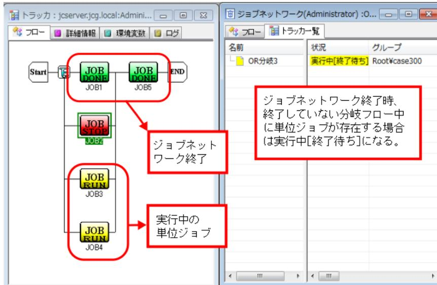
図4.41 ジョブネットワーク終了時に実行中の単位ジョブがある場合のトラッカ状態例
