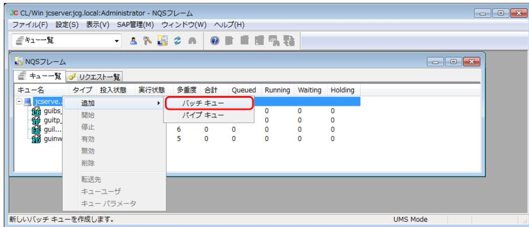
図10.11 バッチキューの新規作成画面例
