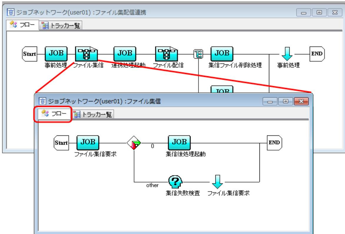
図4.10 サブジョブネットワークの参照例
