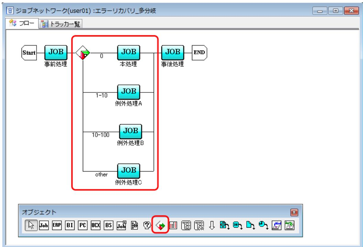
図4.14 条件分岐の配置画面例
