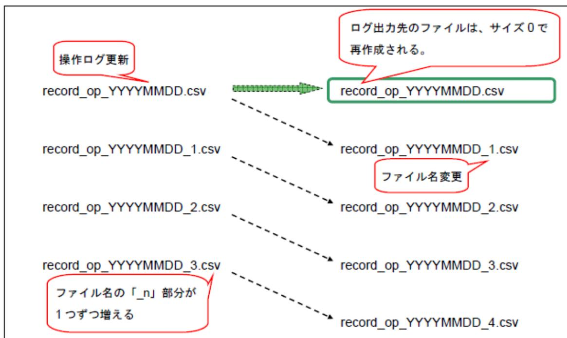
図3.2 ログのバックアップファイル作成
