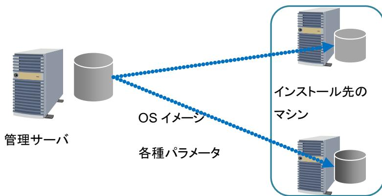
OS クリアインストールは、すべてリモート操作から実行が可能で管理対象マシン側での操作は不要です。あらかじめ必要な設定値をパラメータとして作成しておくことで、通常ローカルセットアップで行うパーティション作成やフォーマット、固有の情報(IP アドレス/コンピュータ名等)の設定などはすべて自動的に行われます。管理サーバからの 1 つのアクションで自動的に完了します。
