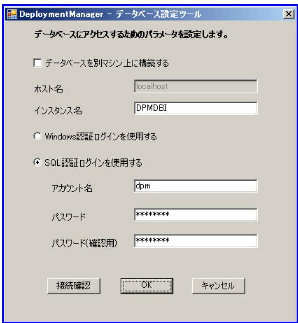
画面が表示された後に、各項目を設定し、「接続確認」ボタンをクリックします。「接続が成功しました」というメッセージが出た後、「OK」ボタンをクリックします。
