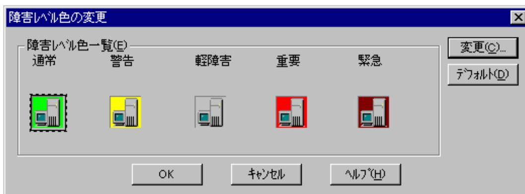
色を変更したいレベルのアイコンをクリックして「変更」ボタンをクリックしてください。「色の設定ダイアログ」が表示されます。「色の設定ダイアログ」の説明については Windows NT や Windows95、98 などのマニュアルやヘルプファイルを参照してください。「デフォルト」ボタンをクリックすると、インストール時の配色に戻します。
