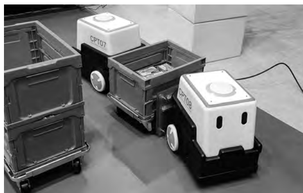
写真8 センサー、ダンパー付きのロボット2台で指定場所まで搬送
