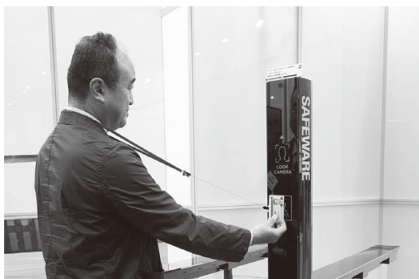
写真1 立ち止まることなくIDカードをかざすだけでゲートを通過できるウォークスルー顔認証
