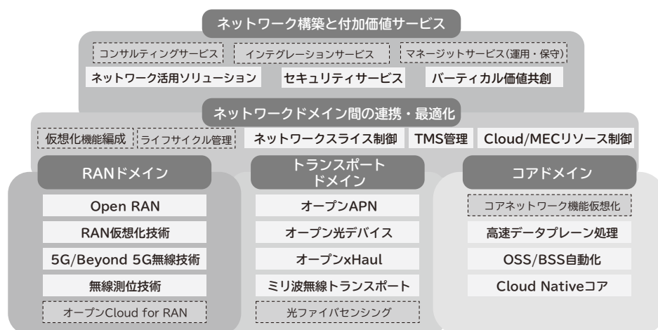
図 NEC オープンネットワークの代表的な技術アセット・提供価値
