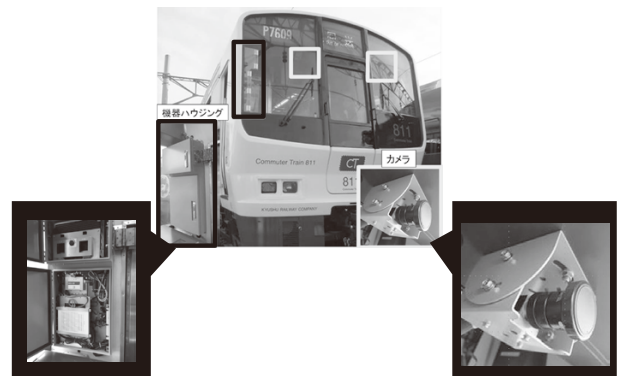
図4 車上局設置状況
