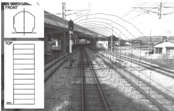
(b) 建築限界(黒色の線)と建築限界 支障検知結果(灰色の矩形)
