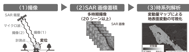
図3 時系列干渉解析における撮像から解析のフロー
