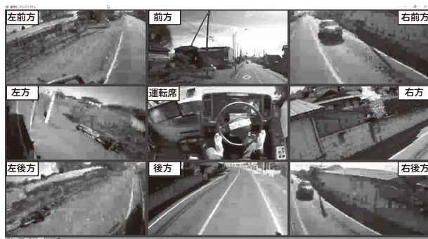
写真2 自動運転バスの公道実証実験の監視画面の例
