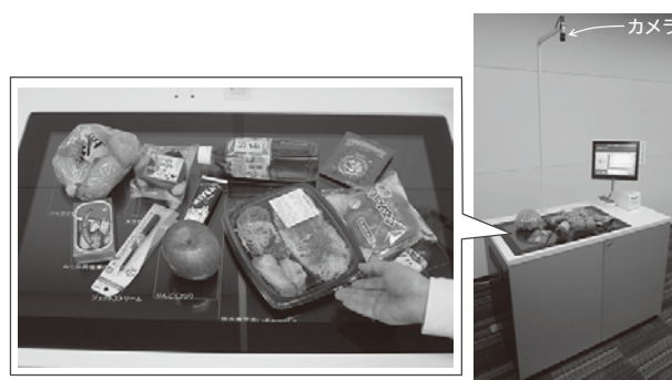
写真2 開発した画像認識POSシステム
