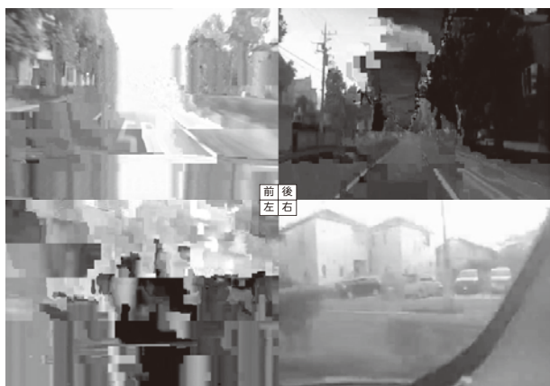
写真1 従来方式で車載映像を伝送したときの例
