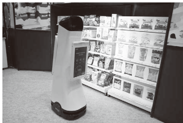
写真6 スキャンしながら移動し、売り場管理を支援するロボット
