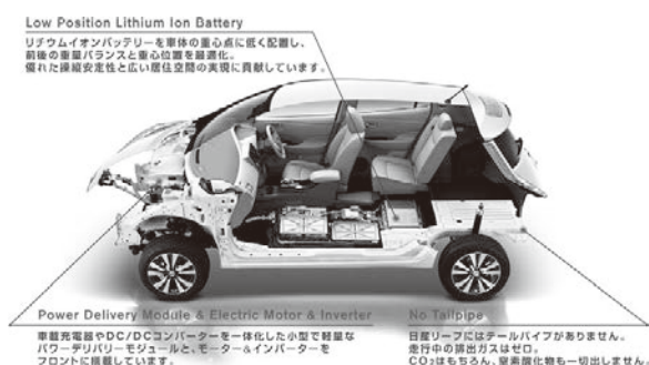
図2 日産リーフの電池搭載図
