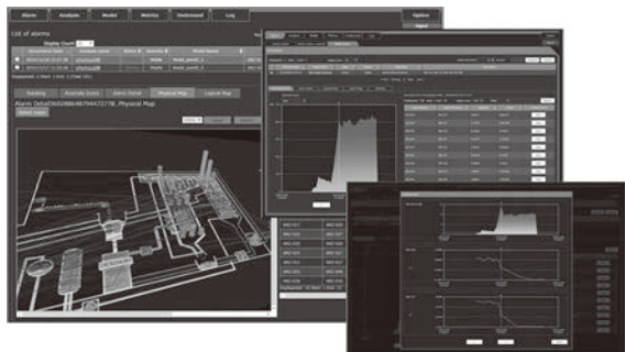
図1 プラント故障予兆監視システム
