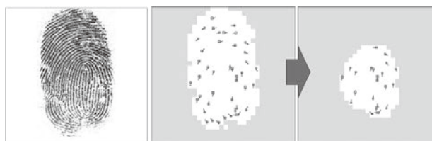
図5 特徴点数削減による計算量削減
