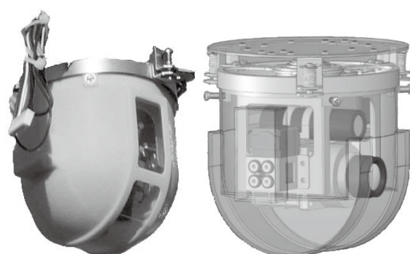
図2 センサジンバル外観と内部構造
