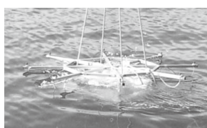
図5 パッシブ音響センサ（プロトタイプ）と主な性能
