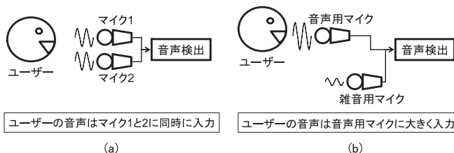
図3 2マイク音声検出におけるマイクの配置例
