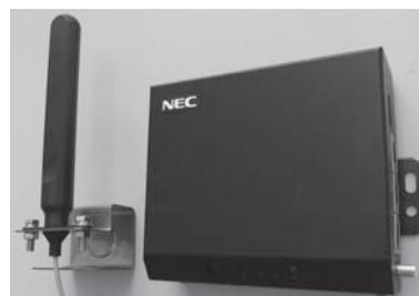
写真4 各種インタフェースと機能を具備したuMルータ
