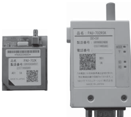
写真2 機器組込みタイプ (左) とD-Sub9ピンタイプ (右)
