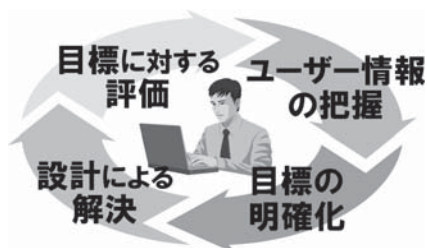
図1 ユーザー中心設計のプロセス
