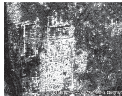
(b) 垂直偏波を60度回転した偏波での送信 / 水平偏波を60度回転した方向での受信
