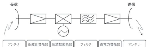
図2 通信/放送衛星中継器の基本構成
