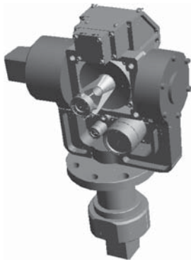
図5 SOTA光学部と捕捉追尾機構の設計結果
