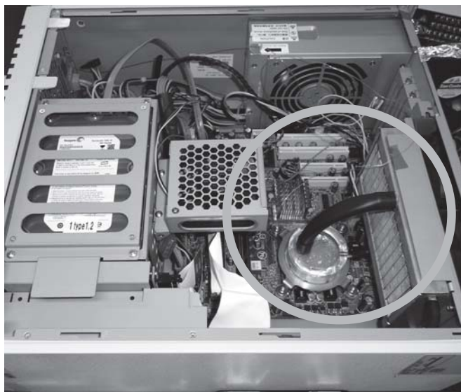
写真 相変化冷却モジュール組込みの様子
