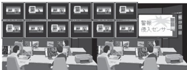
図1 大型表示モニタへの侵入制御情報表示イメージ
