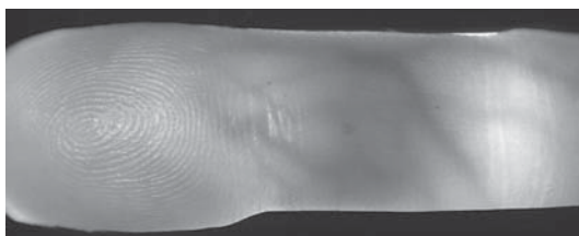
写真5 透過光+反射光による指紋と血管像
