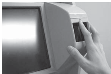
写真9 現金自動預け払い機に搭載されたハイブリッドスキャナ
