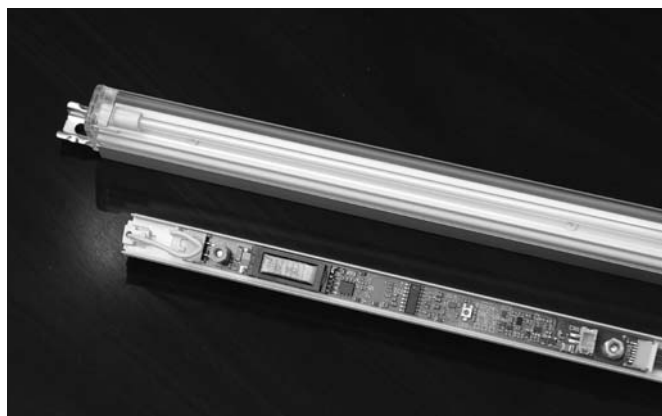
写真1 +CLine (1灯タイプ) と器具にパッケージングされた回路
